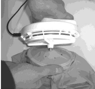
über das Grundgerät gezogen, bis er in der Befestigungsrinne zu liegen kommt. Nachdem der einwandfreie Sitz des Gummizuges in der Befestigungsrinne überprüft wurde, wird die flexible Haube mittels Druckknopf am Boden des Grundgerätes befestigt. Damit ist das Gerät betriebsbereit. Lassen Sie bei Betrieb die flexible Haube immer herunterhängen.
