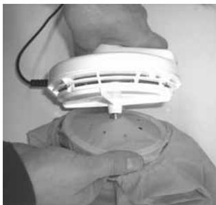
jednotce. Hlavní jednotka se zasune do otvoru kapoty. Pak přejděte gumovým kroužkem umístěným na okraji odsavače nad přístrojem, dokud se nedostane do upevňovacího otvoru. Po zkontrolování, zda je gumový kroužek správně
