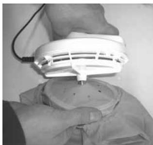
jednotke. Hlavná jednotka sa zasunie do otvoru kapoty. Potom prejdite gumovým krúžkom umiestneným na okraji odsávača nad prístrojom, kým sa nedostane do upevňovacieho otvoru. Po skontrolovaní, či je gumový krúžok správne pripevnený, pripevnite pružný kryt k spodnej časti hlavnej
